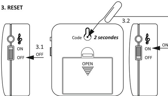
Mettez l'interrupteur sur ON tout en appuyant sur le bouton de reset.
