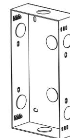
Um die Kabel von der Rückseite oder einer anderen Seite einzuführen, müssen Sie eines der vordefinierten Löcher der Box öffnen. Als nächstes die Box in die Wand einpassen, festschrauben und mit Spachtelmasse fixieren.
